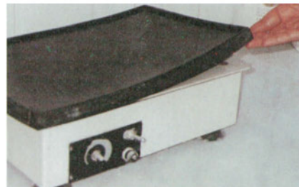
Εικόνα 7.2(β): Αφαίρεση καλύμματος από το δονητή.
