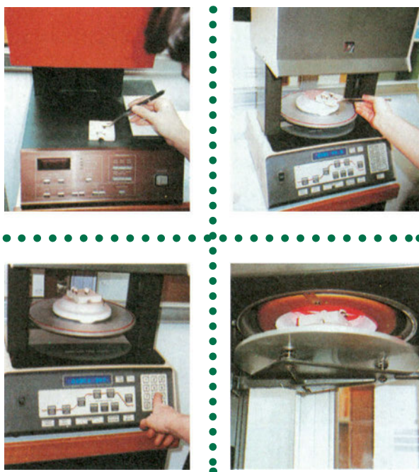
Εικόνα 7.49: Στάδια λειτουργίας συσκευής όπτησης πορσελάνης. (Κλείσιμο του θαλάμου με ανέβασμα της βάσης εργασίας).
